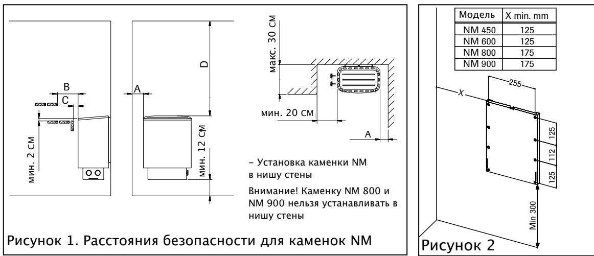
Рисунок 1. Расстояния безопасности для каменок NM
